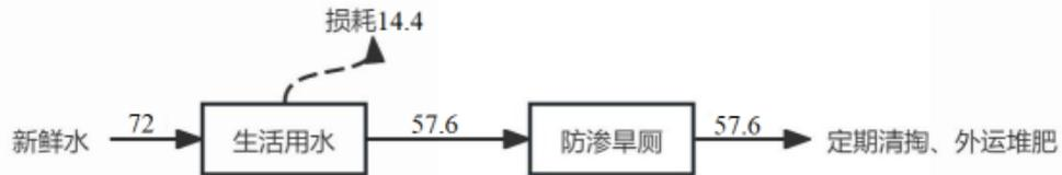
图 2-2 扩建后全厂水平衡图 (单位 t/a)
