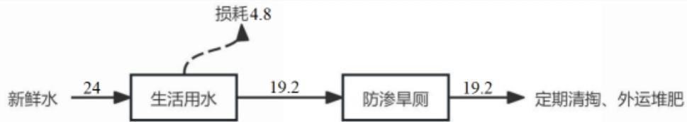
图 2-1 本项目水平衡图 (单位 t/a)
